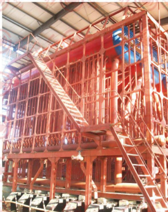
传热的螺纹烟管置于锅壳介质中，烟管传热无直接热损失。设计时螺纹烟管烟速在20m/s左右，可使螺纹烟管受热面不积灰。即使低负荷时产生灰沉积，负荷提高时，螺纹烟管的自卷袭作用，也能将积灰卷走，具有自吹灰作用。同时由于外形尺寸小和烟气回程少，散热损失小。因此本锅炉效率高。
