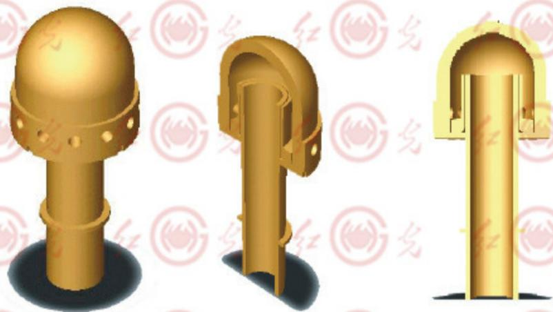
采用独特的钟罩式风帽，具有低阻力、磨损轻、易更换的特点。进风有力均匀，克服了积灰的现象，彻底解决倒渣问题，提高了锅炉的效率。
